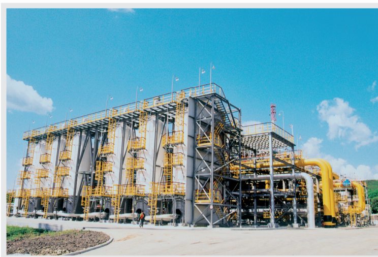
Fig. 6 – Russia, Krasnodar, 2003, impianto di adsorbimento su silica-gel per il gasdotto Gazprom dalla Russia alla Turchia
