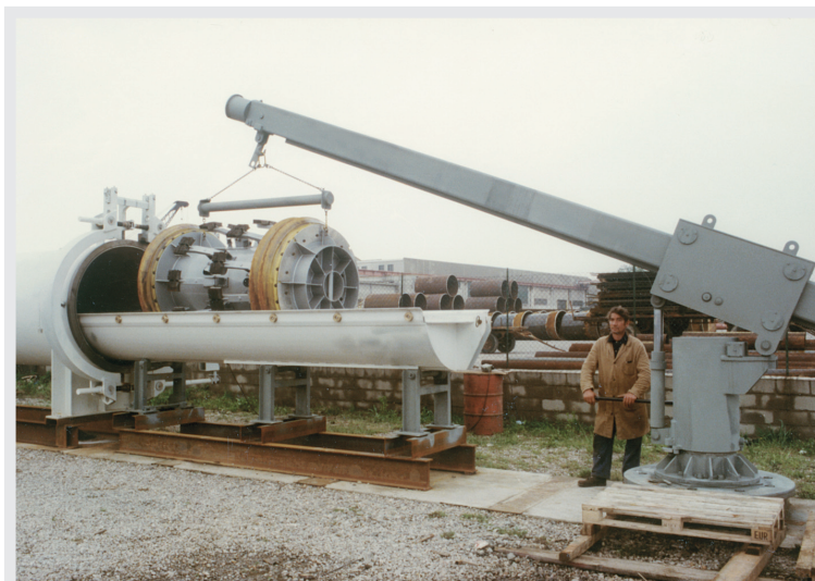
Fig. 2 – URSS, 1977/8, sistema di lancio e ricevimento pig
